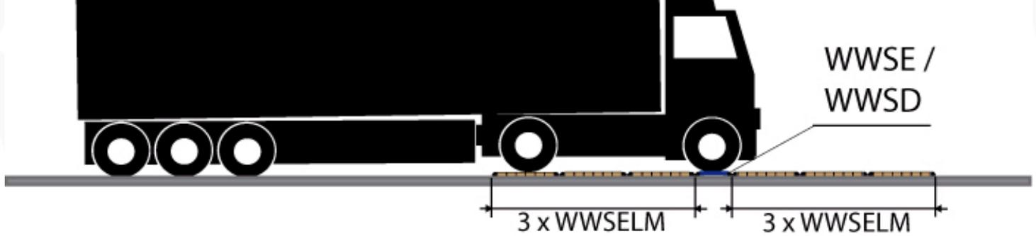
NOTES : Les conditions les meilleures pour un pesage d'essieux est obtenue en créant une zone de nivellement d'une longueur égale au double du véhicule le plus long à peser.
