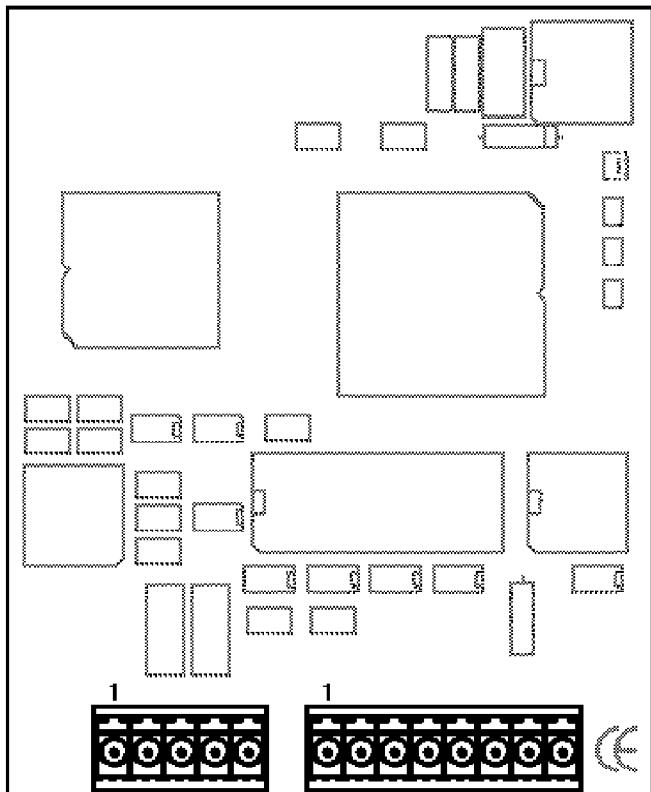
**L'interface bus de terrain (RS 485/différentielle)** est galvaniquement isolée. La vitesse de transmission maximale est de 1,5 Mbit/s. Selectez type PR1721 pour activer le bus de terrain requis. Le logiciel pour l'interface bus de terrain est activé lors de l'enclenchement de l'unité de base. L'interface est livrée avec deux presse-étoupe PG9.
