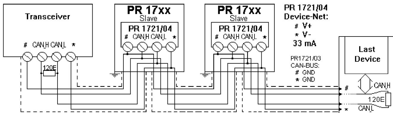
Utiliser un câble bus blindé et torsadé (2x2). Une résistance (120 Ω) terminale sur les deux extrémités du bus est exigée. il faut prévoir des mesures que la compensation du potentiel entre PR17xx et les autres appareils est assurée.
